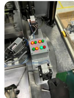
MÓDULO DE PRUEBA DE VOLTAJE PARA VALIDACIÓN DE ESTADO EN SENSOR AUTOMOTRIZ
