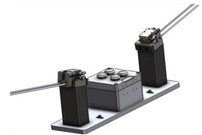
MÓDULO DE PRUEBA DE VOLTAJE PARA VALIDACIÓN DE ESTADO EN SENSOR AUTOMOTRIZ
