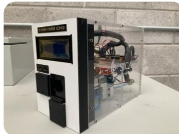
MÓDULOS DE INSERCIÓN Y PRUEBA ELÉCTRICA (POLARIDAD/CONTINUIDAD) EN TERMINALES DE ARNÉSES ELÉCTRICAS
