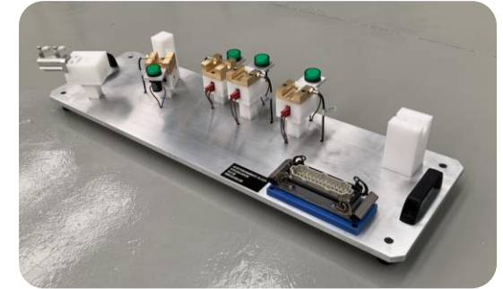
JIGS PARA POSICIONAMIENTO DE COMPONENTES EN ARNÉS ELÉCTRICO
