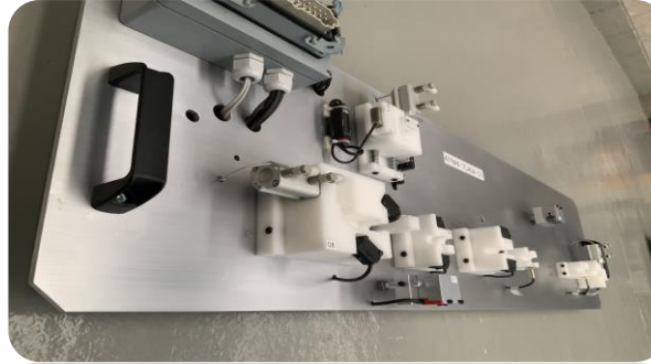
REGLETA DE INSPECCIÓN DE COMPONENTES EN ARNÉS ELÉCTRICO
