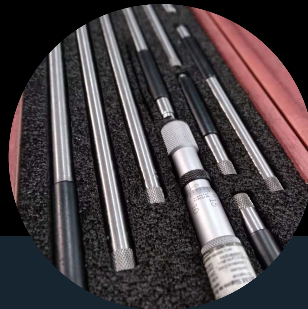
MICROMETRO DE INTERIORES. CAPACIDAD DE MEDICION: HASTA 2 METROS.
