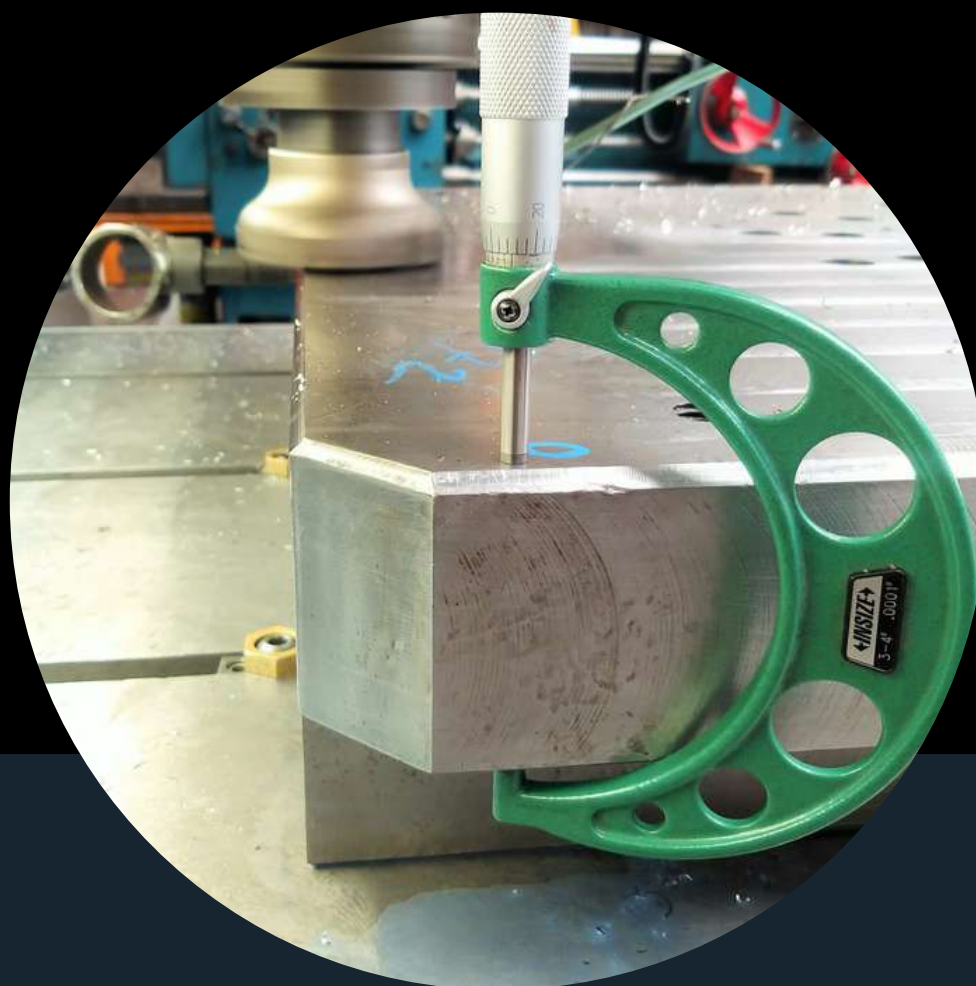
MICROMETRO. CAPACIDAD DE MEDICION: HASTA 1 METRO.
