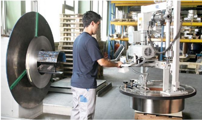
VacuMaster Coil para la basculación de 90° de bobinas de acero inoxidable
