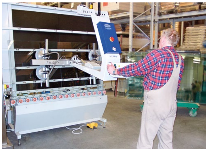
Elevador por vacío VacuMaster Comfort para el volteo de 180° de una luna de cristal o vidrio
