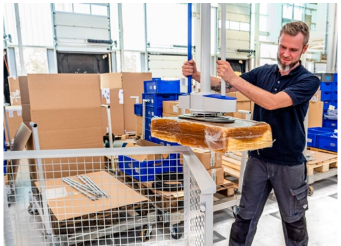
Tubo elevador por vacío Jumbo Low-Stac para la manipulación de balas de caucho virgen
