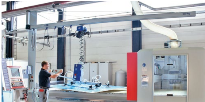
Grúa giratoria de columna SK con polipasto y elevador por vacío VacuMaster
