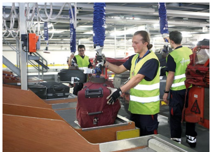
Aeropuerto | Elevador de tubo de vacío JumboFlex para la manipulación de piezas de equipaje
