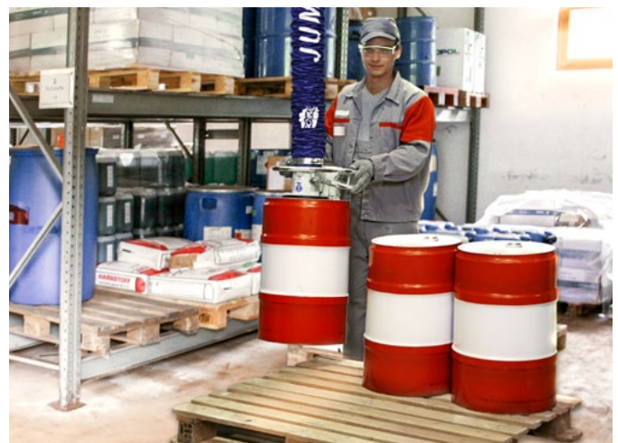
Elevador de tubos de vacío JumboSprint para la manipulación bidones
