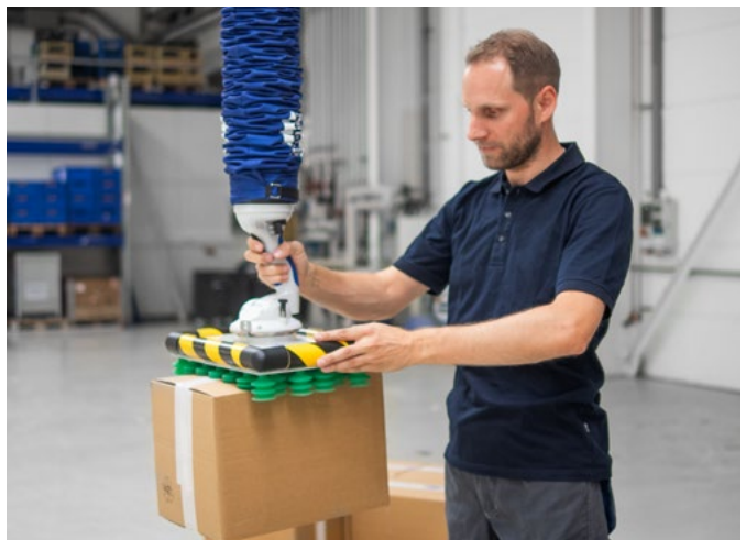
Tubo elevador por vacío JumboFlex para la preparación de cajas de cartón de tamaño y calidad cambiantes en la logística de distribución
