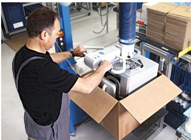
Tubo elevador por vacío JumboErgo para el embalaje de mercancías y la manipulación del embalaje final
