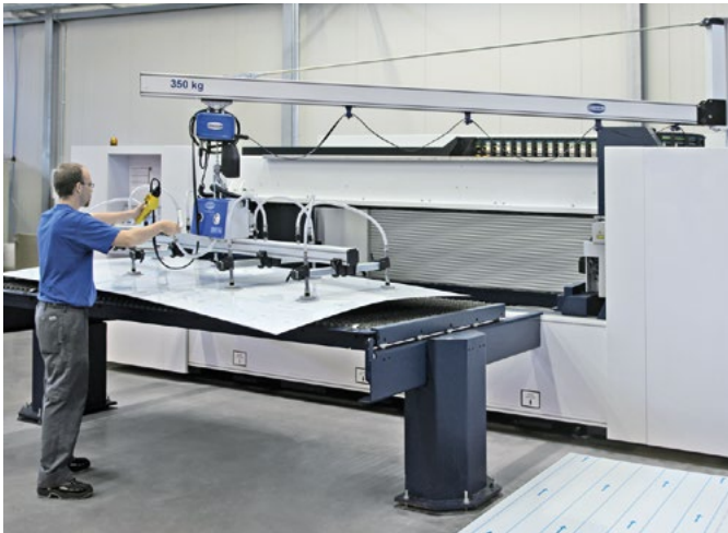
Elevador por vacío VacuMaster Basic para la alimentación o descarga de una máquina de corte por láser
