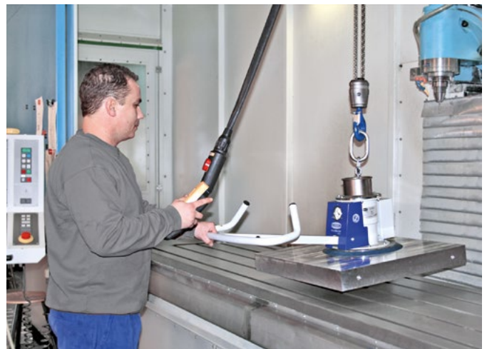
Elevador por vacío VacuMaster Eco para la manipulación de piezas de metal sin energía externa
