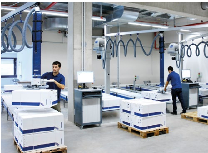
Tubo elevador por vacío JumboErgo para la preparación de expediciones de mercancía
