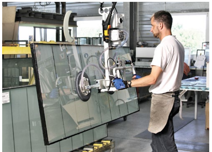
Elevador por vacío VacuMaster Window durante la manipulación vertical de elementos de cristal
