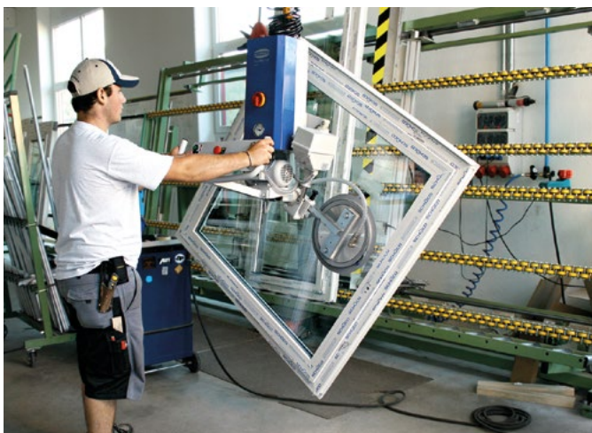
Elevador por vacío VacuMaster Window Comfort para la alimentación y descarga de una prensa de acristalado
