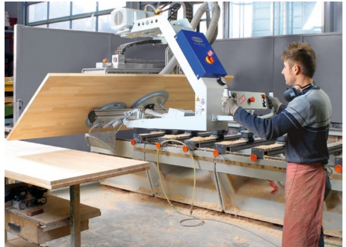
Elevador por vacío VacuMaster Comfort para el volteo de 180° de planchas de madera revestida
