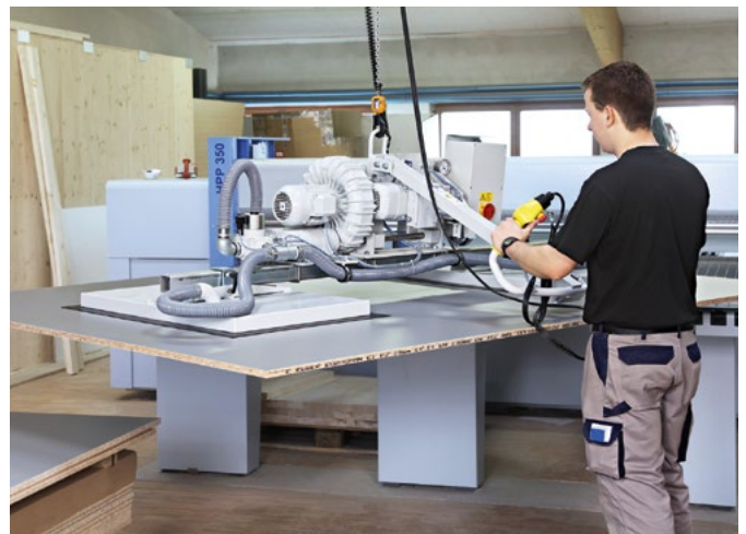
Elevador por vacío VacuMaster Multi, con basculación de 90°, para la manipulación de planchas pesadas de madera porosa
