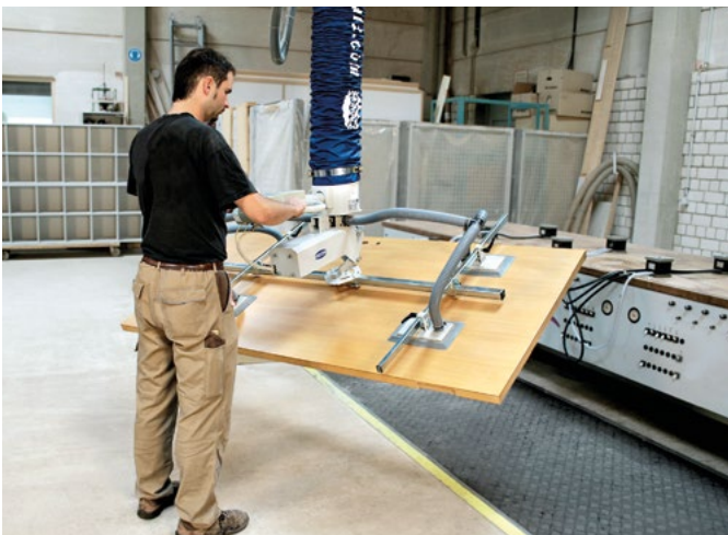
Tubo elevador por vacío JumboErgo, con basculación de 90°, para la alimentación de un centro de mecanizado CNC
