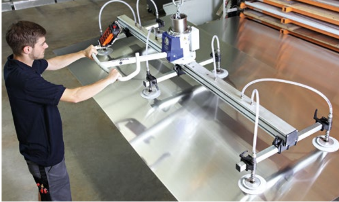
VacuMaster Eco para la retirada de chapas de acero de un sistema de estanterías
