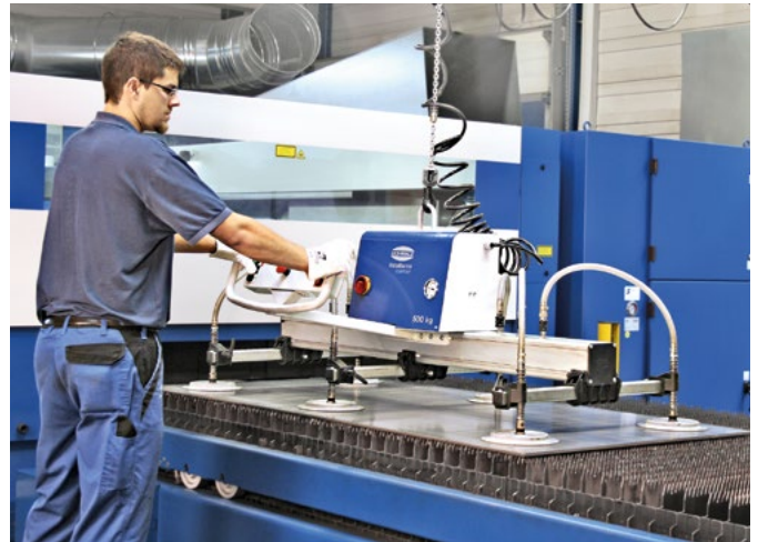
Elevador por vacío VacuMaster Comfort para la alimentación o descarga de una máquina de corte por láser
