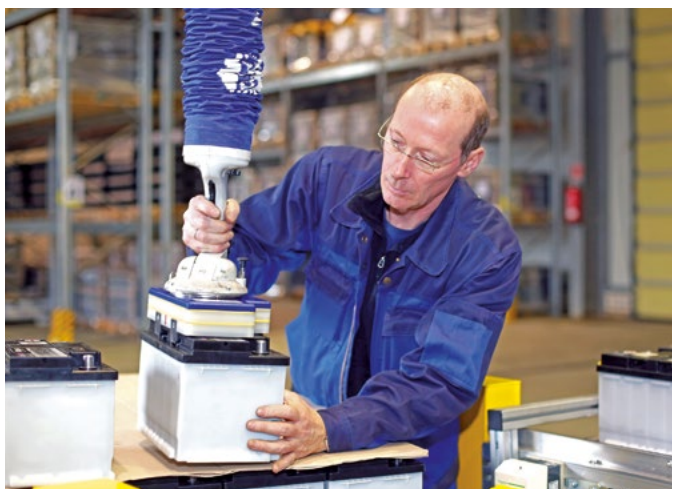
Tubo elevador por vacío JumboFlex Battery para la manipulación de baterías
