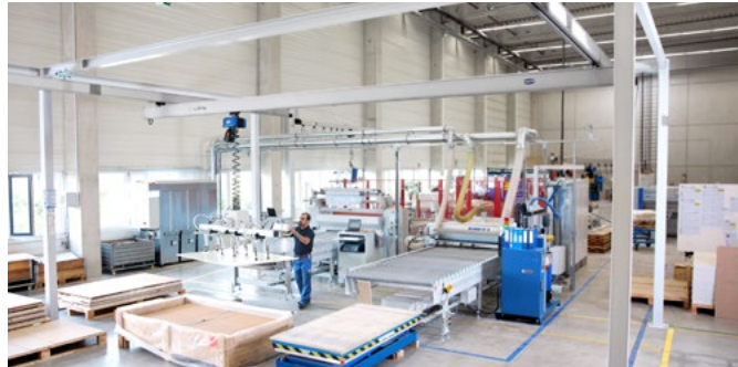
Puente grúa de aluminio SRA con tubo elevador por vacío VacuMaster
