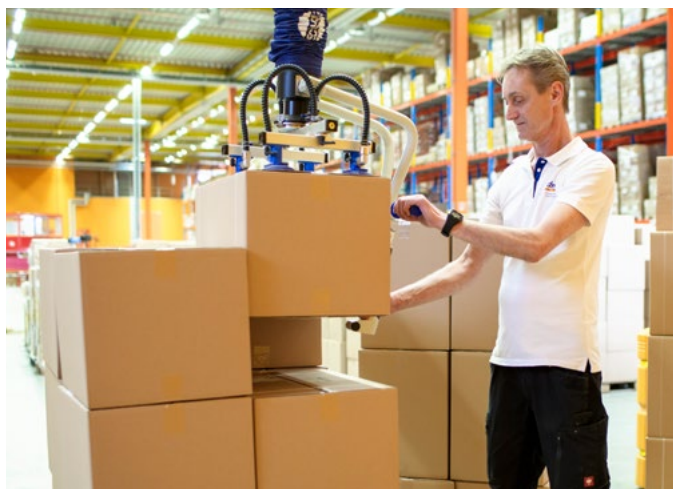
Tubo elevador por vacío JumboFlex High-Stack para la manipulación segura de diversas piezas hasta una altura de apilado de 255 cm
