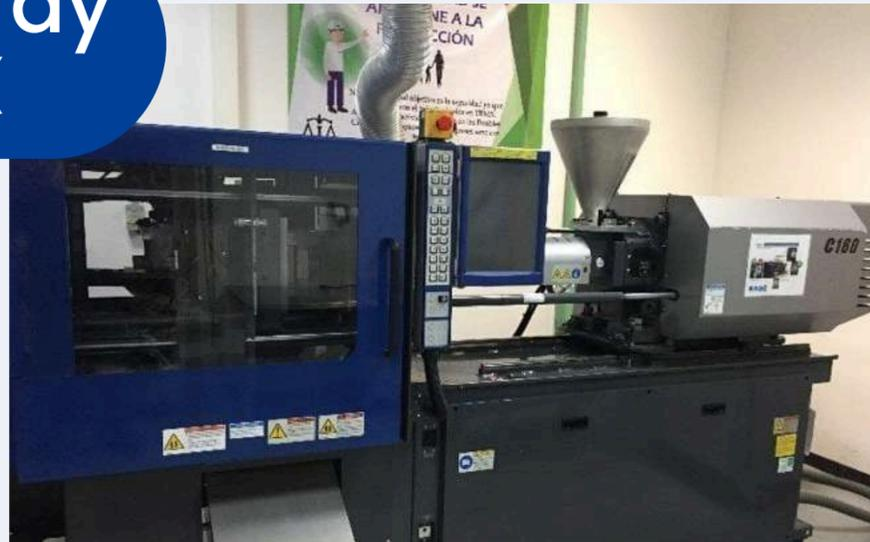
Máquina de moldeo por inyección
