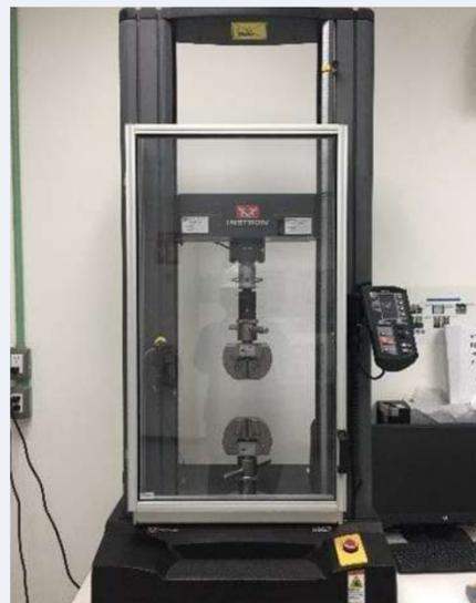
Equipos de prueba de tracción/flexión
