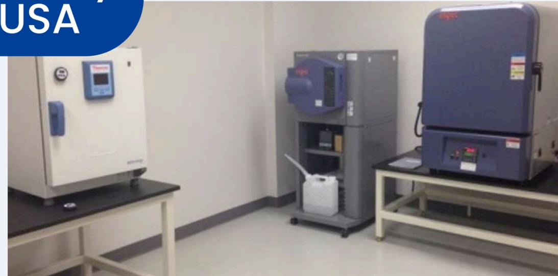
Prueba de envejecimiento (cámara de temperatura / humedad constante / PCT)
