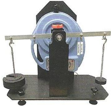
COMPROBACIÓN MEDIANTE PESOS MUERTOS EN MEDIDORES DE TORQUE
