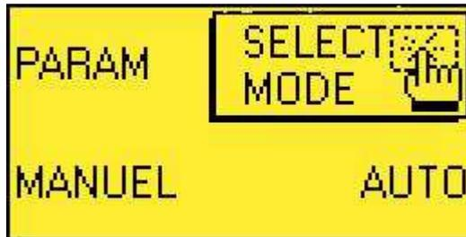
Oprimir sobre la tecla
