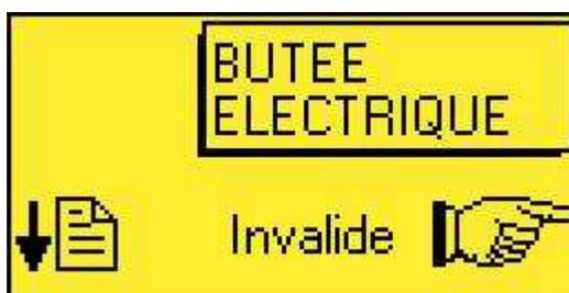
Oprimir la tecla
